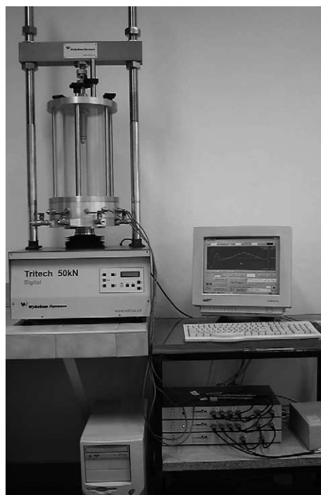
Ryc. 4. Stanowisko do badań własności sprężystych (BES)
